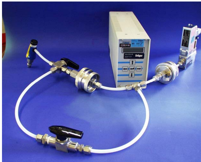
Bild 1: Probenahmeverrichtung für Öl in Druckluft gemäß EAB
