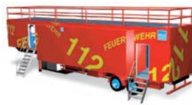
Mobile Atemschutz-Übungsanlage: Im Sattelaufleger mit seitlich herausfahrbarer Sektion zur Erweiterung des Platzangebotes während des Trainings.
