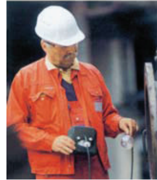
德尔格X-am 7000: 功能强大的内置泵一是专业人员进入密闭空间的最佳选择。
