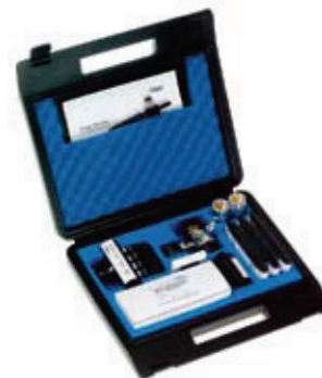
Aerotest Simultan HP 所有必须部件都装在整套系统内
