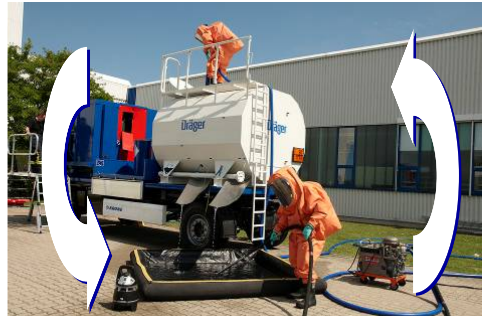
Auffangen und Pumpen im Kreislauf
