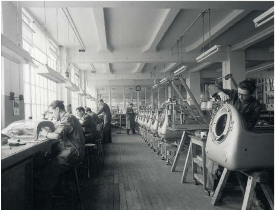
Serienfertigung der Eisernen Lunge im Drägerwerk
