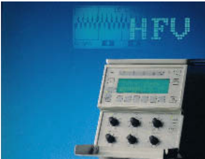
Babylog 8000. Integriertes grafisches Monitoring mit einer Echtzeitkurve des Flows im Verfahren SIMV. Oberhalb des Gerätes: Echtzeitkurve des Flows in einer Hochfrequenzbeatmung
