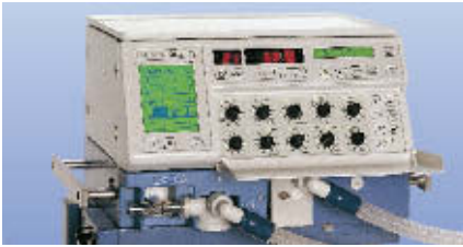
Evita 2. Konventionelle Bedienung über Drehknöpfe, grafische Darstellung und Textmeldungen auf dem Bildschirm
