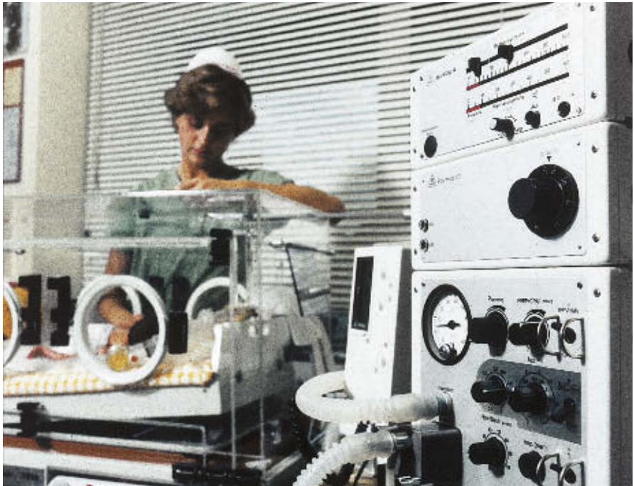
Babylog 1 zur Beatmung von Kleinkindern. Zusätzliche Module über dem Beatmungsgerät zur Einstellung der Sauerstoffkonzentration und zur Überwachung des Beatmungsdrucks
