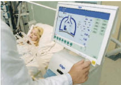
Grafische Darstellung der Lungenmechanik im Smart Pulmonary View: Änderungen der Resistance und Compliance erkennbar in einem Modell des Atemapparates
