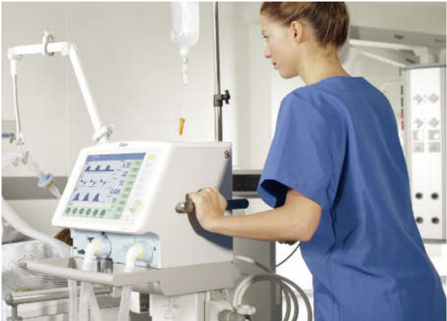
Savina 300 – Intensivbeatmung mit Umgebungsluft unabhängig von zentraler Gasversorgung
