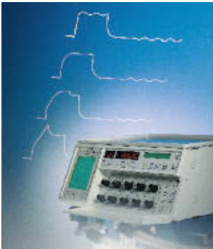
Vita 2 und die Entwicklung der Verfahren. Beatmungsdruckkurven von unten nach oben: volumenkontrolliert, druckbegrenzt, konventionell druckkontrolliert und BIPAP
