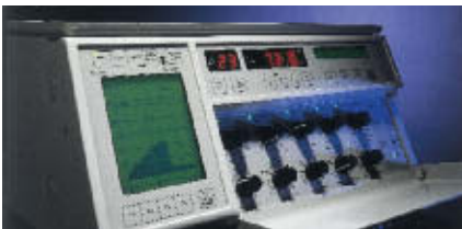
Überwachungseinrichtungen einer Evita. Die numerischen Werte neben dem Grafik- bildschirm sind nach Priorität geordnet
