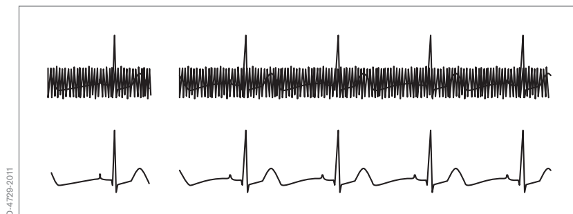
Abb 41 - Typische netzspannungsbedingte Störeinflüsse
