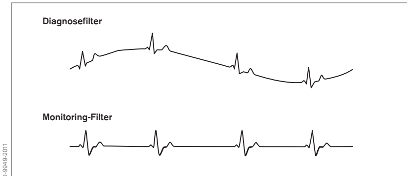
Abb 45 - ST-Verzerrung durch Monitoring-Filter; der Monitoring-Filter verhindert Grundlinienwanderung, erzeugt aber eine ST-Senkung
