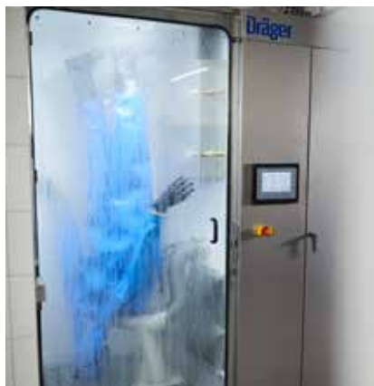
Специализированная моечная машина для ДАСВ и изолирующих костюмов
