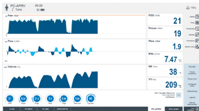
図 2 : 高圧相レベルでの自発呼吸を伴う PC-APRV
