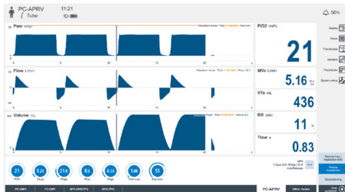
図 1 : AutoRelease 機能がオンの時の PC-APRV と秒で示した 低圧時間の測定値
