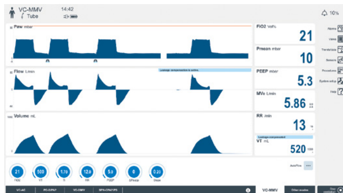
図 2 : VC-MMV/AutoFlow 強制換気と自発呼吸を伴う
