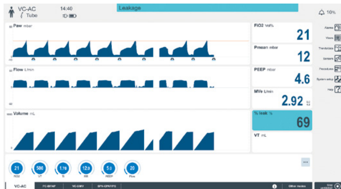
図 1 VC-AC、リーク補正なしの大きなリークを伴う表示例
