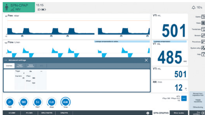
図 2 作動中 NIV 向けの SPN/CPAP/PS 設定ウィンドウの例
