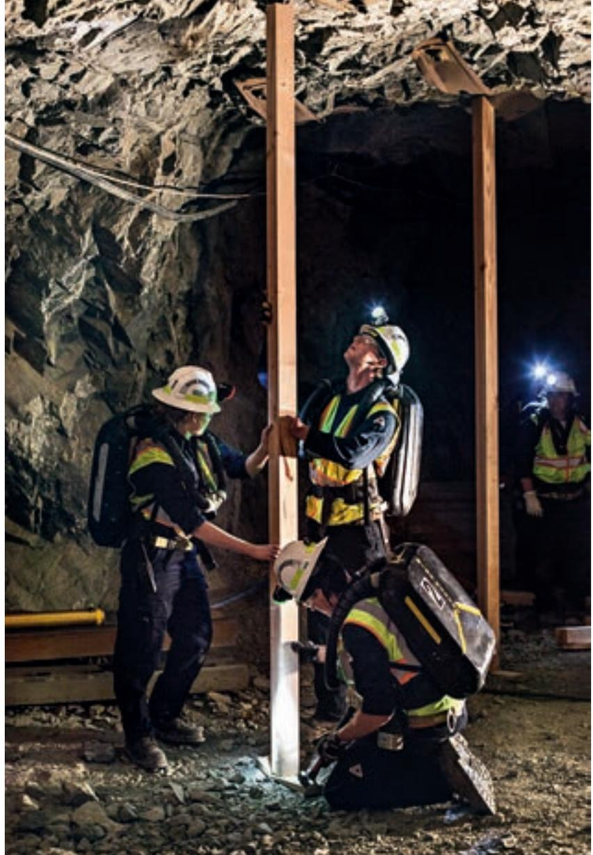
**Alles eine Frage der Übung: Die fast drei Meter langen Pfeiler („Stempel“) sollen die instabile Decke stützen – Grubenwehren trainieren regelmäßig den Ernstfall**
