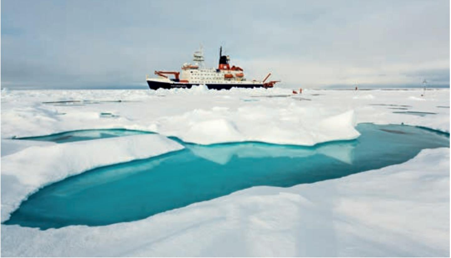
Heimat am Horizont: Die 118 Meter lange und mit vier Motoren von zusammen 14.000 Kilowatt (20.000 PS) ausgerüstete Polarstern ist eines der weltweit wenigen Forschungsschiffe, die als Eisbrecher gebaut wurden
