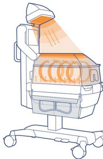
Babyleo con le pareti laterali aperte. Quando le pareti laterali vengono aperte, Babyleo incrementa automaticamente la duplice cortina d'aria, così la temperatura nel vano paziente si mantiene stabile.
