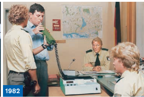
Alcotest 7010 con sensor óptico con infrarrojos
