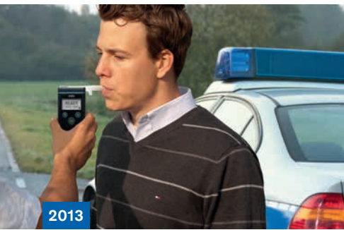
2013 Alcotest 6820: Funcionamiento del sensor/Índice de protección mejorados. Carcasa y pantalla mejoradas
