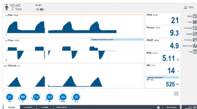
Figura 2 Esempio di schermata con VC-AC, perdita significativa con compensazione delle perdite
