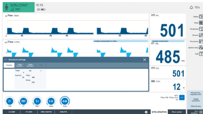
Figura 2 Esempio di finestra delle impostazioni SPN/CPAP/PS per la modalità NIV attivata
