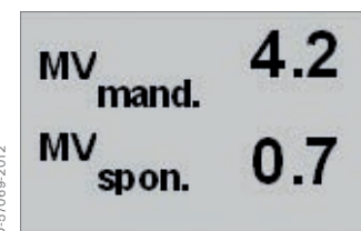
Fenêtre de paramètres configurable en option, qui sépare le volume minute total en deux parties : le volume minute expiratoire spontané et le volume minute respiré avec des mouvements de ventilation imposés.
