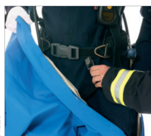
Si el traje está equipado con un ajuste de altura, colocar el gancho en el cinturón de la cadera del equipo autónomo de respiración...
