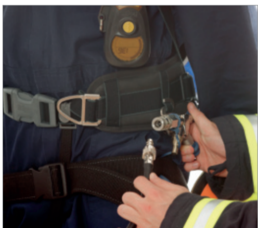
Si el traje está equipado con una válvula de regulación PT 120L o Air-Connect, unir el tubo de presión interno con el equipo de respiración.
