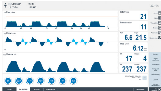
Fig. 1 PC-BIPAP con respiración mecánica mandatoria y espontánea
