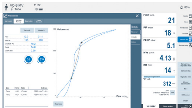
Fig. 2 Ejemplo de pantalla del menú de evaluación tras la maniobra de bajo flujo
