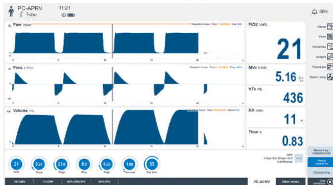
Fig. 1 PC-APRV con AutoRelease activado y T_{baja} medida en segundos
