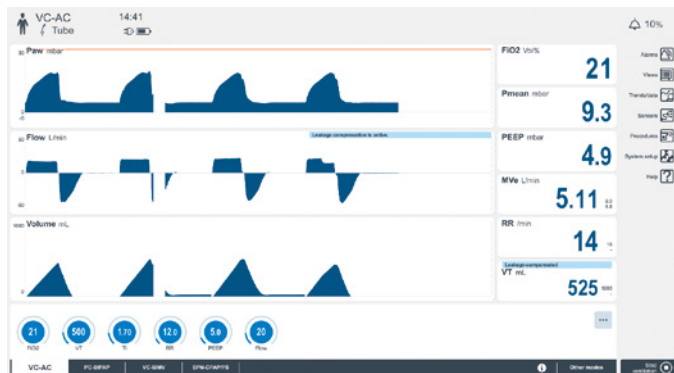
Fig. 2 Ejemplo de pantalla con VC-AC, gran fuga con compensación de fugas
