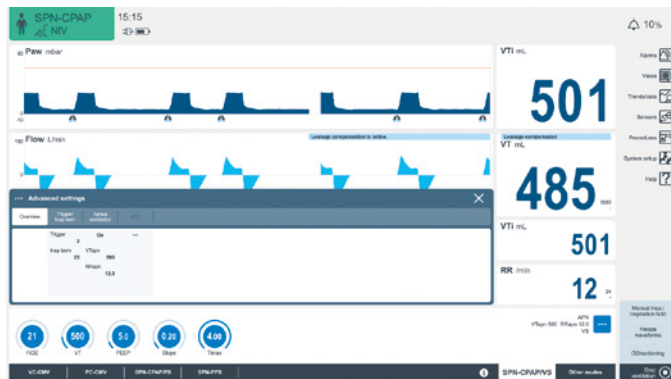
Fig. 2 Ejemplo de una ventana de ajustes de SPN/CPAP/PS con NIV activada
