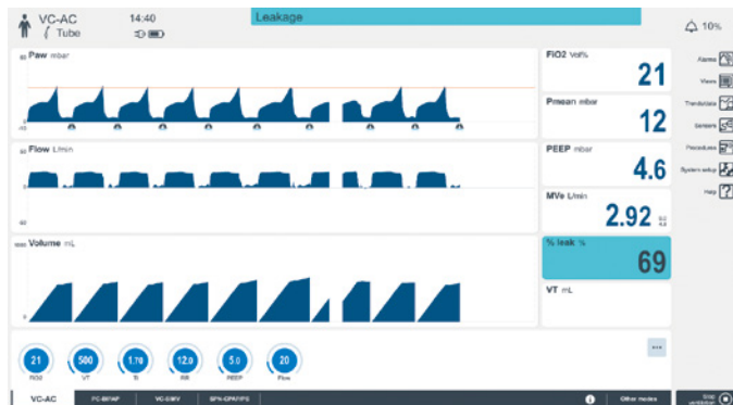
Fig. 1 Ejemplo de pantalla con VC-AC, gran fuga sin compensación de fugas
