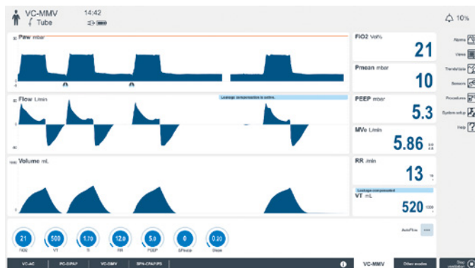
Fig. 2 VC-MMV/AutoFlow con respiración mandatoria y respiración espontánea
