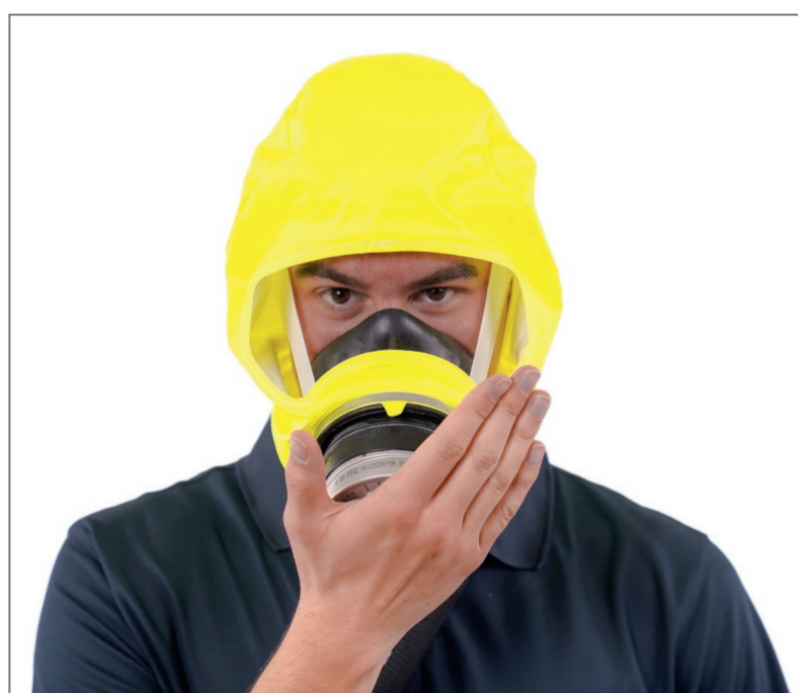
Controllare la tenuta della semimaschera tappando l'apertura anteriore del filtro con il palmo della mano. Inspirare.
