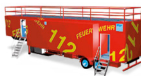
Parcours mobile d'entraînement à la protection respiratoire : remorque avec extension latérale pour augmenter l'espace d'entraînement.
