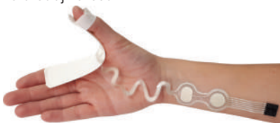
Postavljanje senzora za ruku za jednokratnu uporabu i njegovih elektroda
