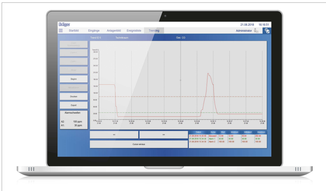
Das Trending ermöglicht einen Rückblick auf die Messwert- und Alarmhistorie einer Messstelle.
