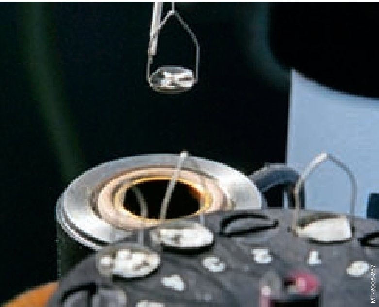
Probe, vorbereitet für die Thermogravimetrie (siehe Seite 29)
