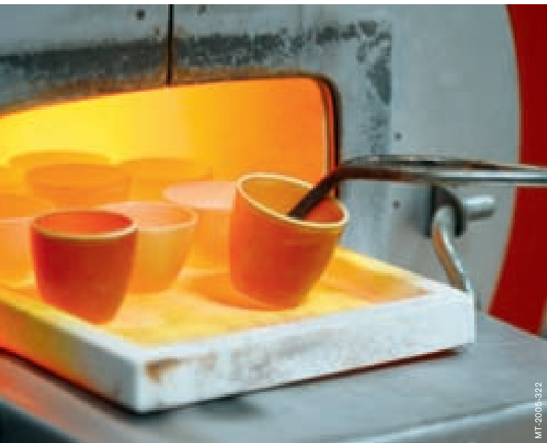
Bei etwa 850 Grad Celsius werden Porzellantiegel ausgeglüht
