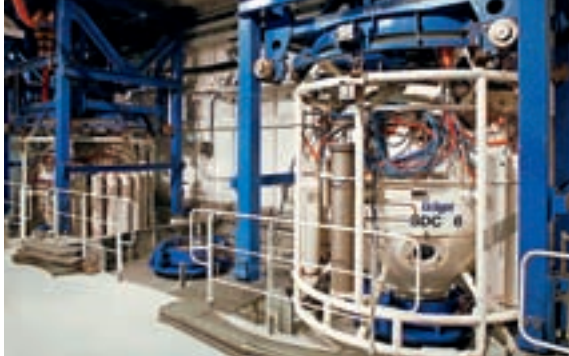
Objectif, les fonds marins : les bathyscaphes pour les plongeurs en saturation sont prêts à l'emploi dans un bateau de base. Ils permettent de descendre les plongeurs en surpression à plusieurs centaines de mètres
