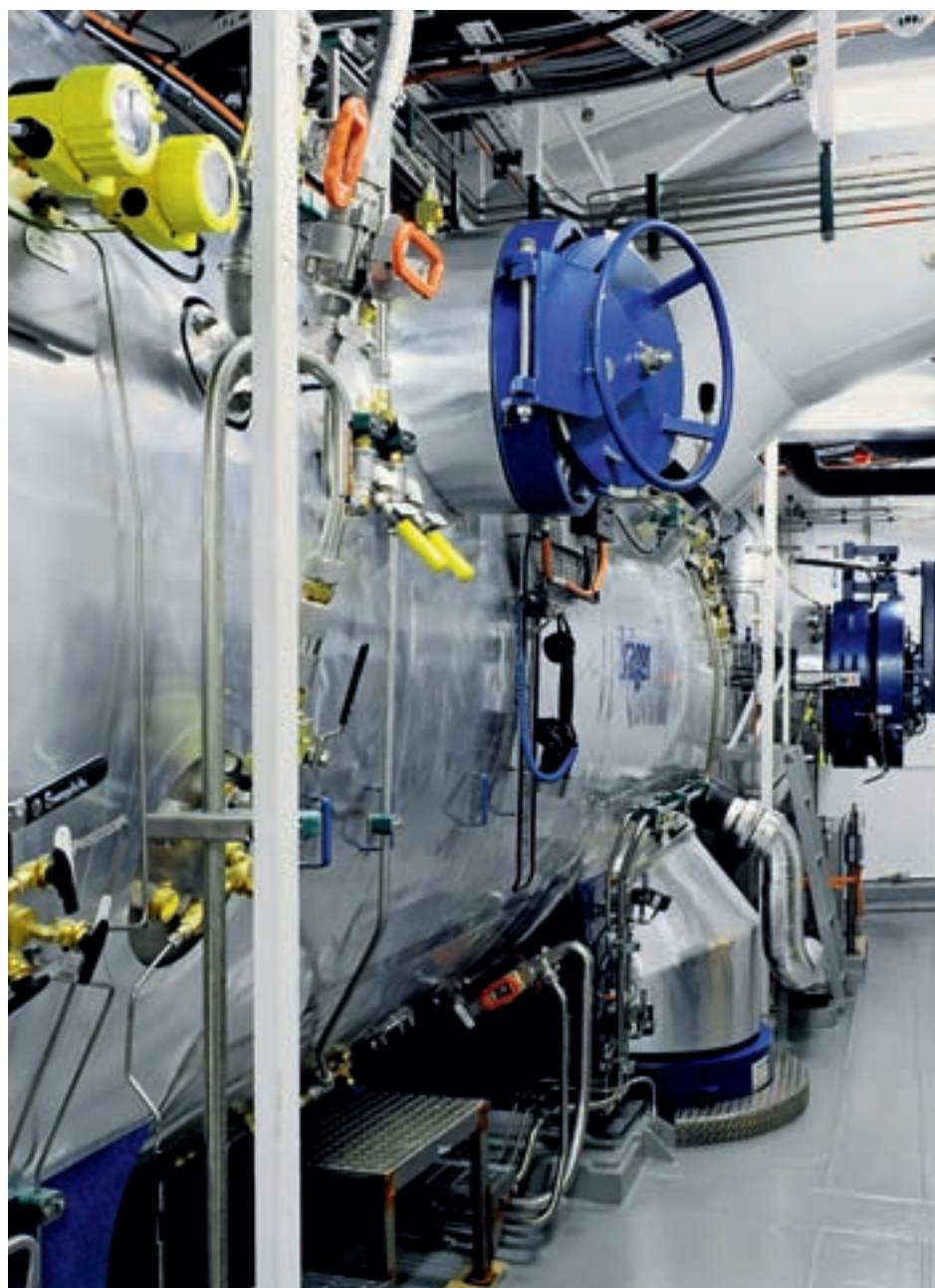
Vivre dans un cylindre : les caissons hyperbares abritant les plongeurs pendant plusieurs semaines constituent le cœur du bateau norvégien spécialisé « Seven Havila »
