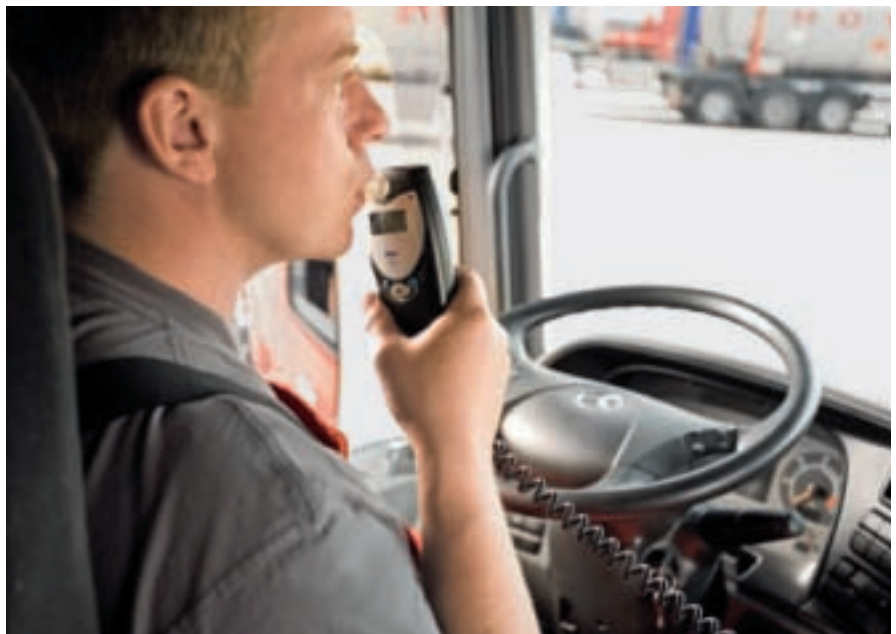
Atemalkoholgesteuerte Wegfahrsperrre: erst pusten, dann starten.
