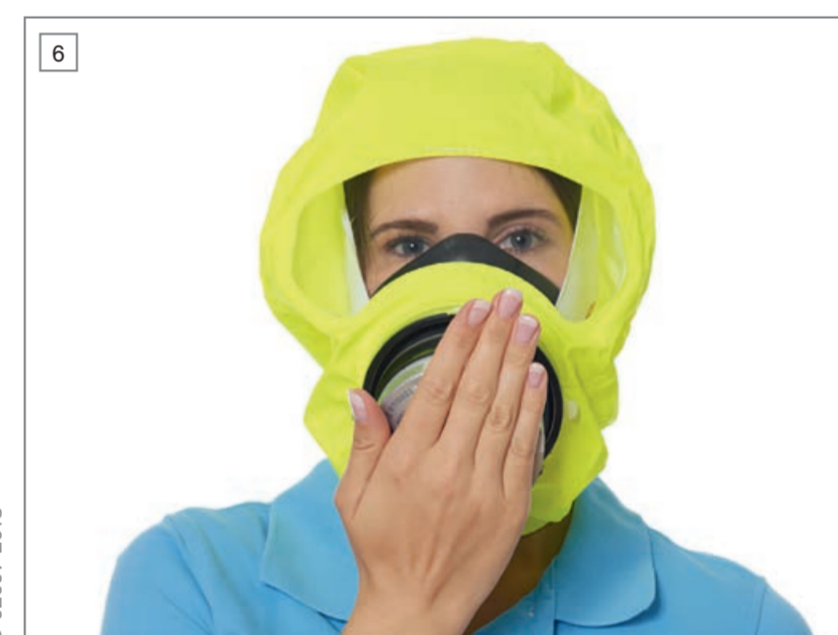
Controllare il posizionamento della semimaschera coprendo con il palmo della mano l'apertura filtrante anteriore. Se non si avverte alcuna pressione negativa, sistemare la semimaschera in modo tale che sia ben vicina al naso e alla bocca.
