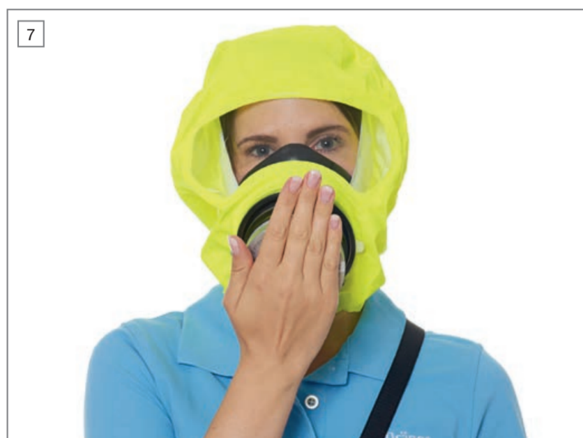
Controllare il posizionamento della semimaschera coprendo con il palmo della mano l'apertura anteriore del filtro. Se non si avverte alcuna pressione negativa, sistemare la semimaschera in modo tale che sia ben vicina al naso e alla bocca.
