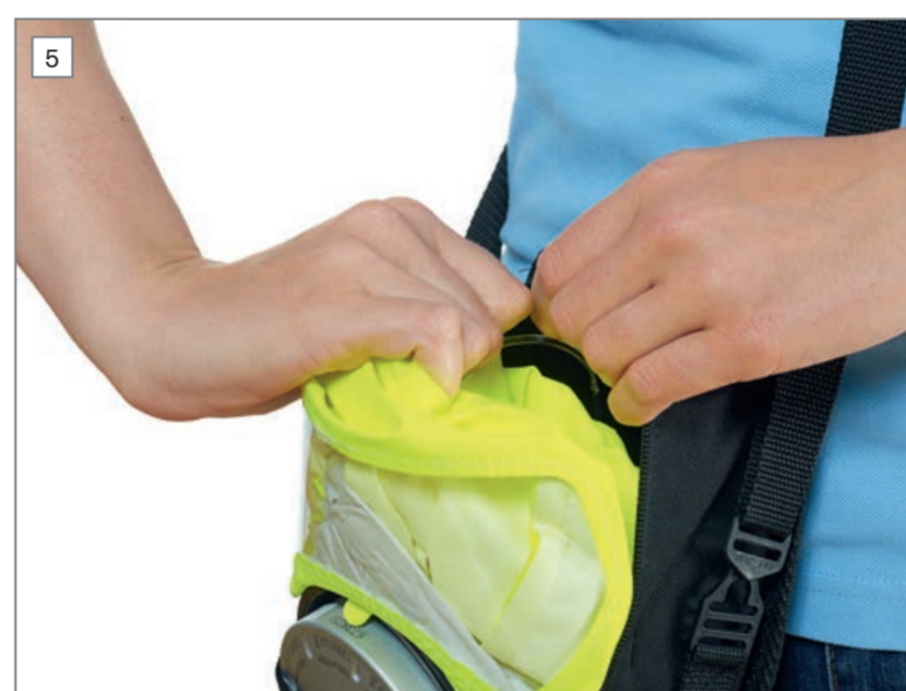
Togliere il cappuccio dalla custodia morbida. Sganciare il cappuccio dal supporto ad asola & uncino per aprirlo automaticamente. Estruendo il cappuccio, il secondo tappo sigillante del filtro sarà automaticamente rimosso.
