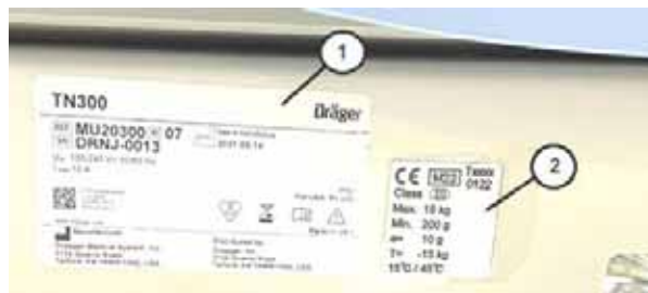
Fig. 9 Côté de l'appareil : Étiquette "Informations sur le fabricant" et étiquette "Informations sur la balance"
