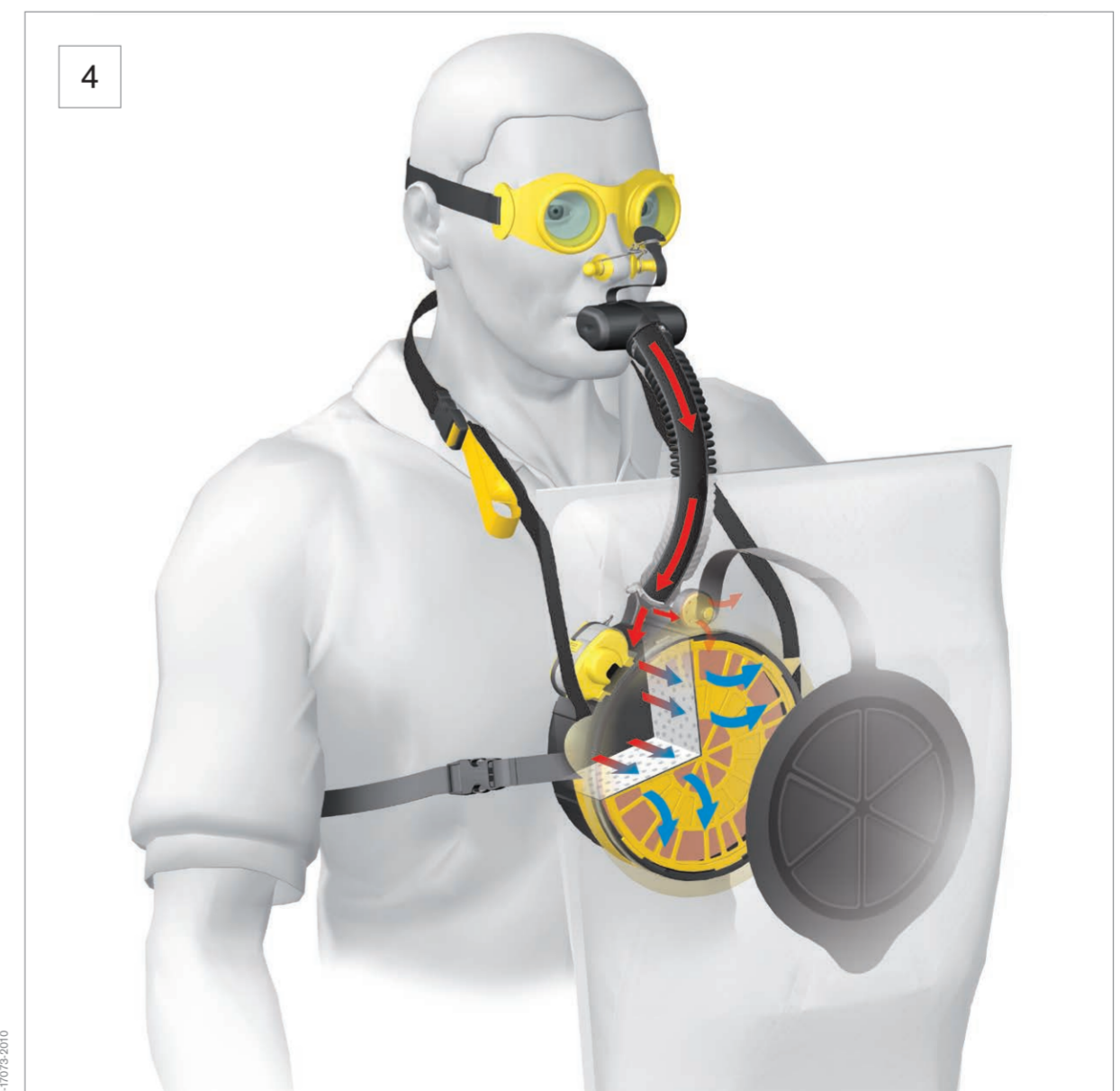
4 Ausatmung mit Überschussabgabe Exhalation cycle and purge of O 2 overproduction
